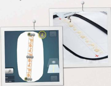
Die B 700 Stickmaschine ist mit einem **Stickmodul** mit extragrosser Stickfläche (400×210 mm) ausgestattet
